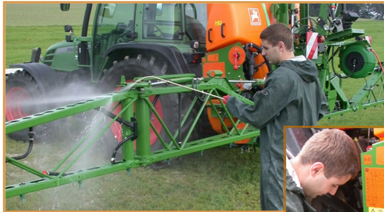
Außenwascheinrichtung, oben Frischwassertank, rechts
