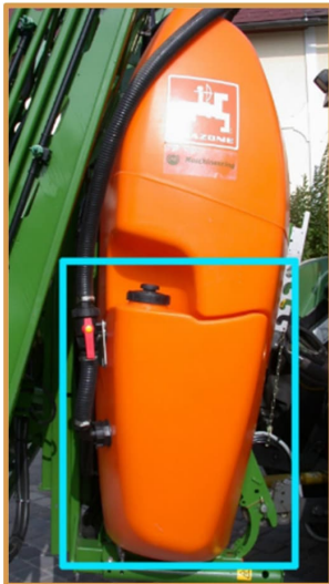
Ein Reinwassertank erleichtert die Arbeit. Altgeräte sind nachrüstbar.
