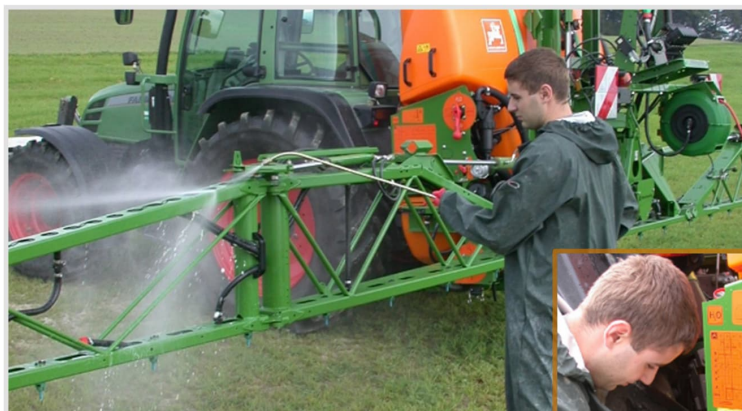
Außenwascheinrichtung, oben Frischwassertank, rechts
